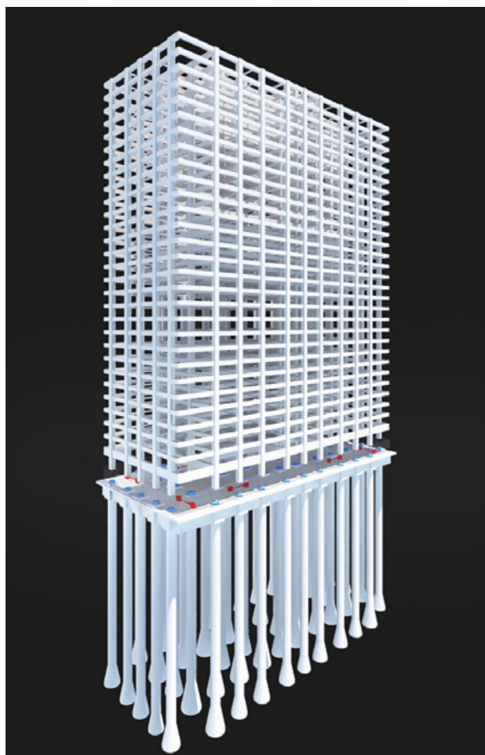
リーフシティ市川ザ・タワーの免震構造の概念CG
