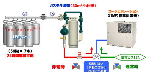
停電対応ガスエンジン概念図
