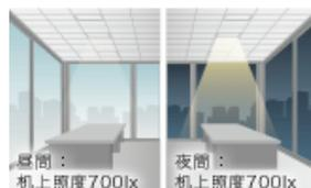
光センサーで室内の光を感知し、自動で明るさを調節する照明器具を採用。快適性を損なわずに、消費電力を抑えることができます。
