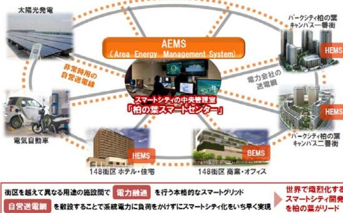
街全体でエネルギーを効率的に利用するため、街のエネルギー情報を一元的に管理し、マネジメントする機能を担うのが、図の中心にある「柏の葉スマートセンター」のエリア・エネルギー・マネジメント・システム (AEMS)。2014 年春に竣工予定の駅前 148 街区の施設内に計画しています。
